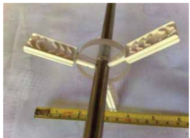
FIGURA 4. Vista do eixo e dos impelidores do sistema de pós-tratamento com lodo ativado (PT).
