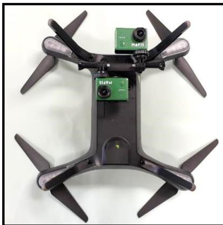
Figura 6. Sensores Mapir 3 RGB e Mapir 3 NIR/InfraRED acoplados ao RPA 3DR Solo.
