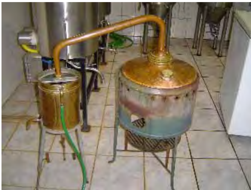
Figura 9 – Alambique de cobre utilizado na destilação do vinho fermentado de gengibre.
