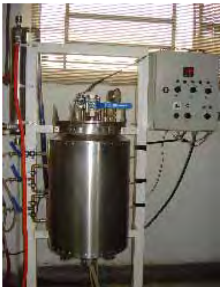
Figura 7 – Reator utilizado no processo de hidrólise da suspensão de gengibre.
