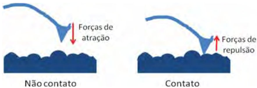
Figura 11 Esquematização do modo de operação não-contato e contato do microscópio de força atômica.
