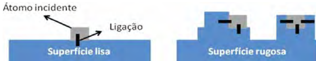
Figura 40 Esquematização de superfícies lisas e rugosas a nível atômico. Na superfície lisa as espécies que chegam possuem menor dificuldade de dessorção devido à menor quantidade de ligações disponíveis. Já em uma superfície rugosa, a incorporação de átomos se torna mais estável pela maior quantidade de ligações prováveis.
