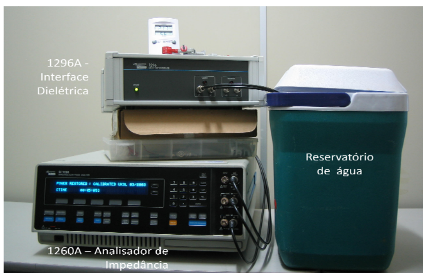
Figura 3.4 - Analisador de impedância Solartron 1260A acoplado a interface 1296A e o reservatório de água com paredes de isolador térmico para manter a temperatura da amostra constante.
