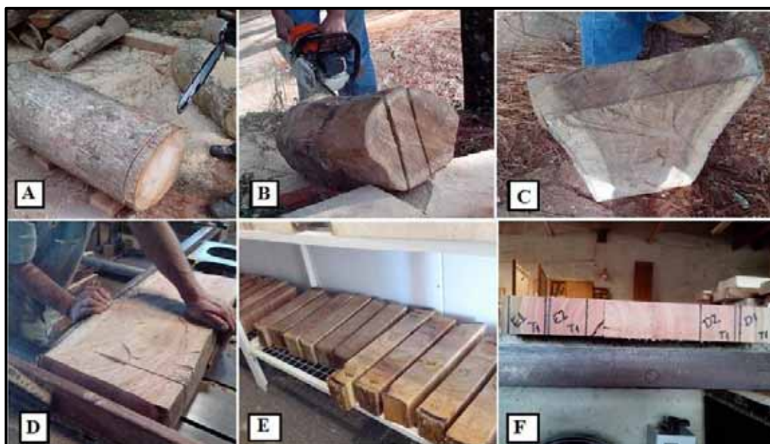
Figura 1. Coleta das amostras- árvores adultas. A) retirada dos 3 discos do torete; B) retirada da prancha central do torete restante; C) prancha central; D) retirada da faixa diametral para ensaio de dureza Janka; E) faixas diametraais para ensaio de dureza Janka; F) demarcações feitas para o corte das faixas diametraais e dos caibros. E e D referem-se, respectivamente, às regiões da esquerda e da direita da medula.
