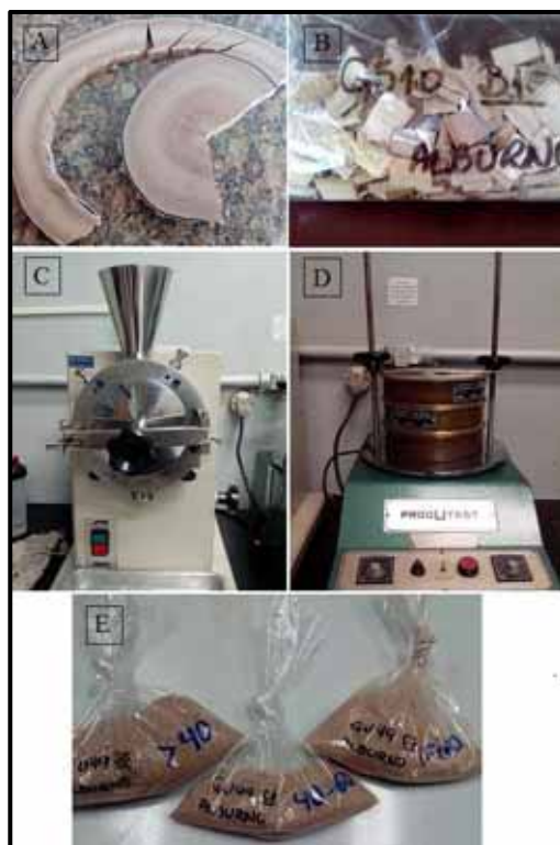
Figura 7. Etapas de preparação das amostras para as análises químicas. A) separação das frações de cerne e alburno. B) redução de cada fração em cavacos. C) moinho de facas do tipo Willey, onde os cavacos foram transformados em serragem. D) peneiras classificatórias. E) frações da amostra já separadas pela peneira classificatória.
