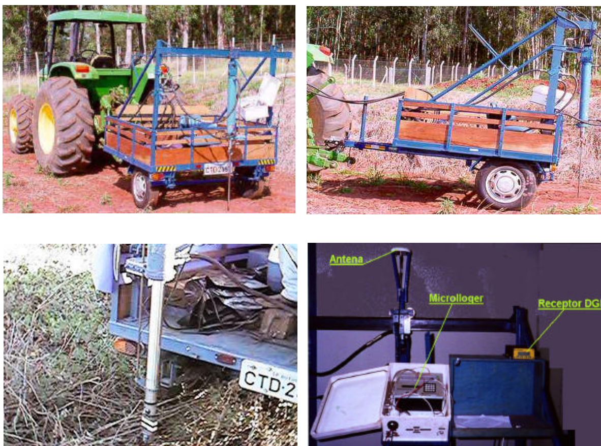
FIGURA 2. Vista do penetrômetro hidráulico eletrônico equipado com sistema DGPS e suas aplicações à campo.
