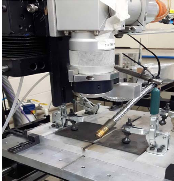
Figura 16 - Equipamento para a realização da soldagem a Laser
