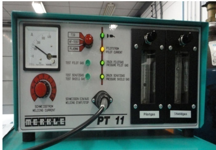
Figura 18 - Módulo de Plasma da marca MERKLE BALMER modelo PT 11.
