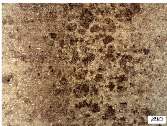
Figura 56 – Micrografia transição ZTA e MB do aço 300M, situação PTT 3.
