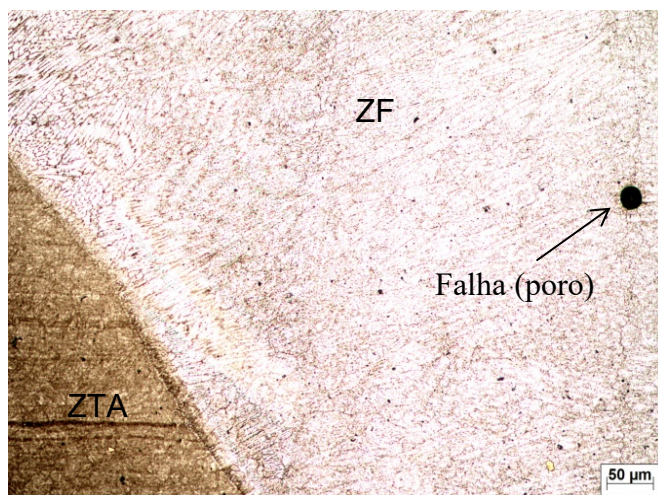
Figura 66 – Cordão de solda situação LTT 1.
