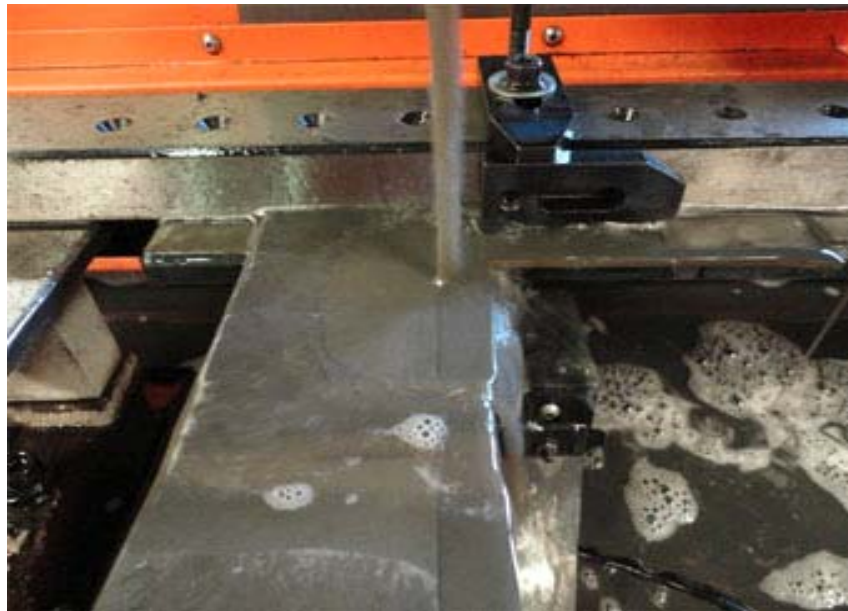
Figura 23 - Confeção dos corpos de prova utilizando eletroerosão a fio.
