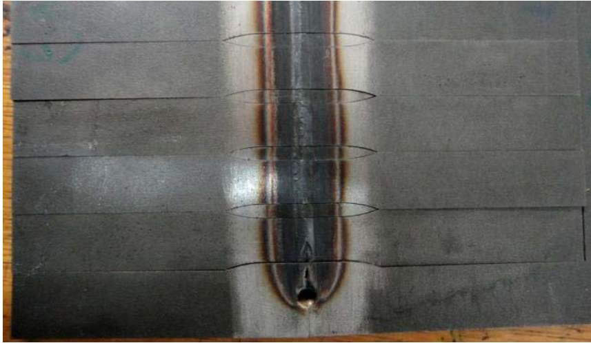
Figura 24 - Modelo de corte do CDP e o material para metalografia.
