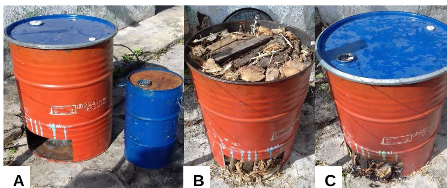
Figura 3 (A, B, C). Forno rústico utilizado para confecção do biochar
