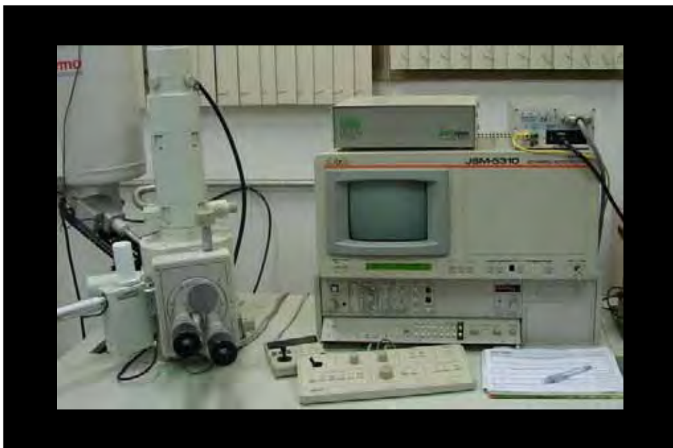
FIGURA 8 - Microscópio Eletrônico de Varredura (MEV) utilizado para a análise de superfície das resinas compostas.
