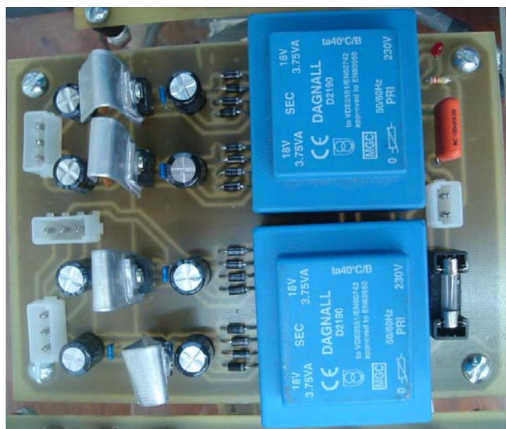
Figura B.8: Placa de Alimentação auxiliar.
