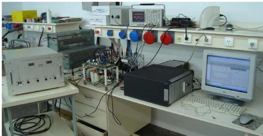
Figura B.1: Montagem Experimental do Inversor Boost Monofásico.
