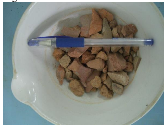
Figura 34 - Material cerâmico da brita nº 1
