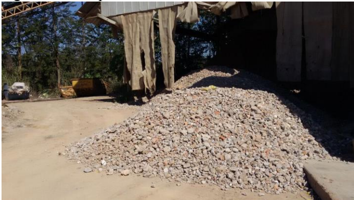
Figura 27 – Depósito de britas recicladas da usina RCC
