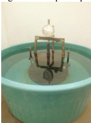
Figura 6 – Corpo-de-prova em imersão na água
