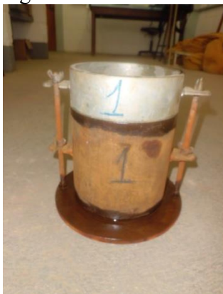
Figura 5 – Molde cilíndrico montado para CBR
