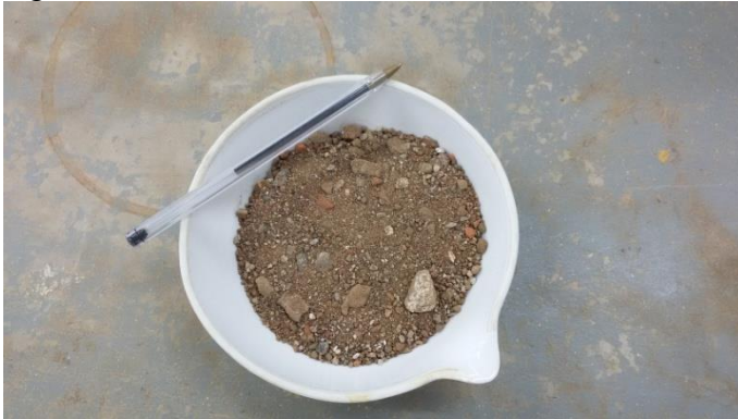
Figura 40 – Material fino da brita nº 2 reciclada
