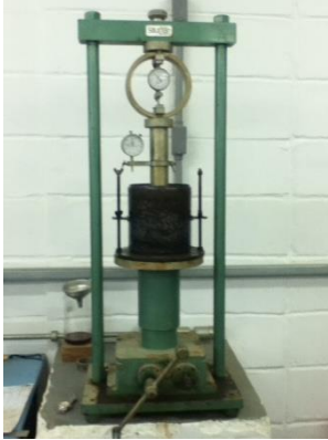
Figura 7 – Ensaio de penetração de CBR
