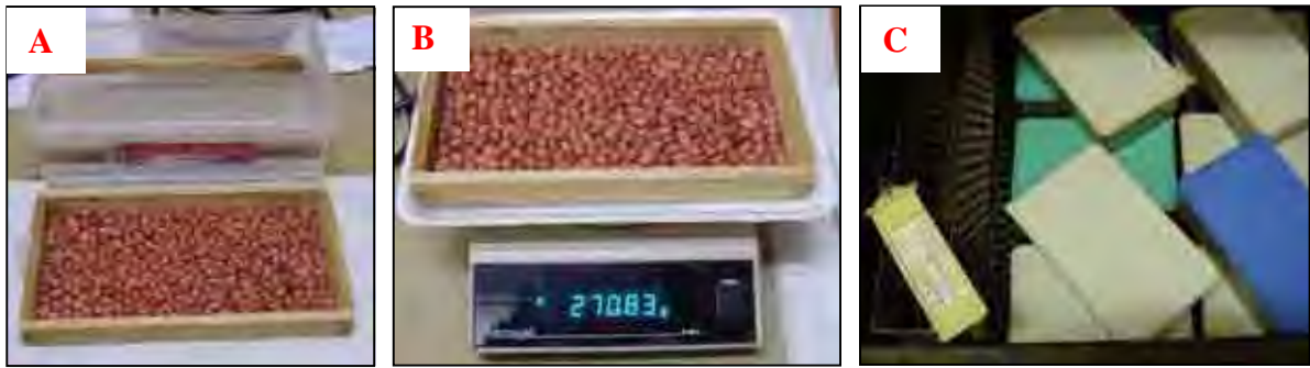
Figura 2. A - Adaptação da metodologia de embebição pelo método da atmosfera úmida, simulando um gerbox; B – Pesagem das sementes para obtenção dos valores iniciais e finais, os quais determinaram os respectivos teores de água nas sementes; C – Processo de embebição em germinador a 25°C. UNESP – Jaboticabal, 2006.
