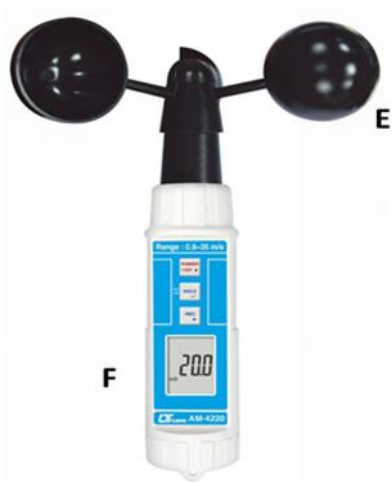
Figura 7 - Instrumentação - anemômetro digital
