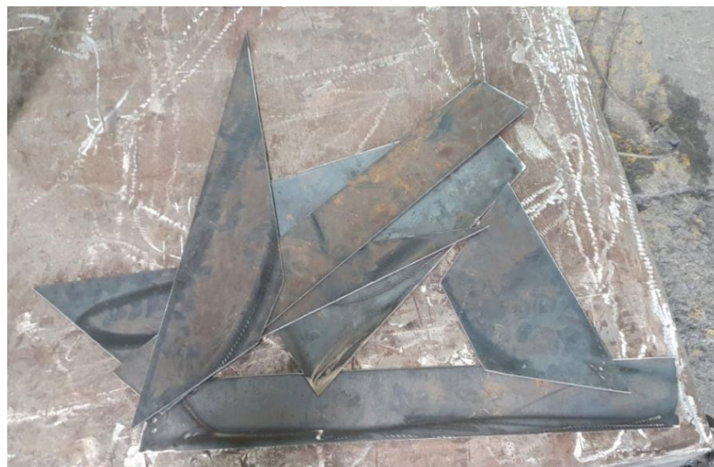
Fotografia 3- Chapas de aço cortadas na máquina de corte a plasma CNC.
