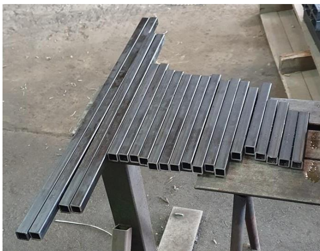
Fotografia 1 – Tubos serrados nas dimensões definidas para montagem.
