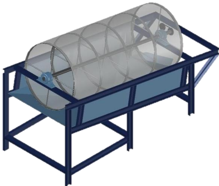
Figura 14 – Vista isométrica 1 da peneira em 3D
