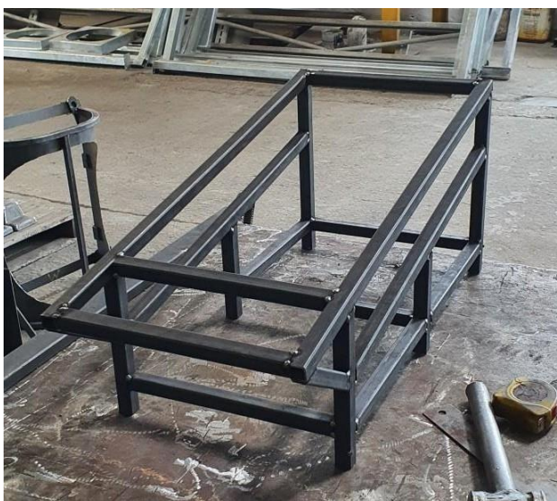
Fotografia 2 – Estrutura base da peneira.
