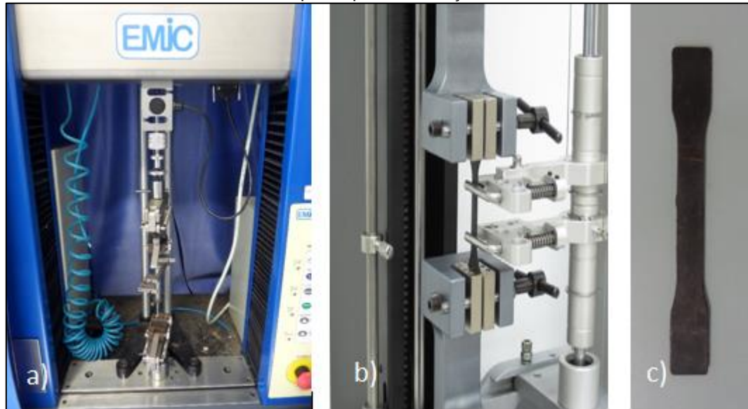
Figura 14. a) Equipamento Emic para teste de flexão e tração, b) Ensaio de tração sendo realizado e c) Corpo de prova de tração.
