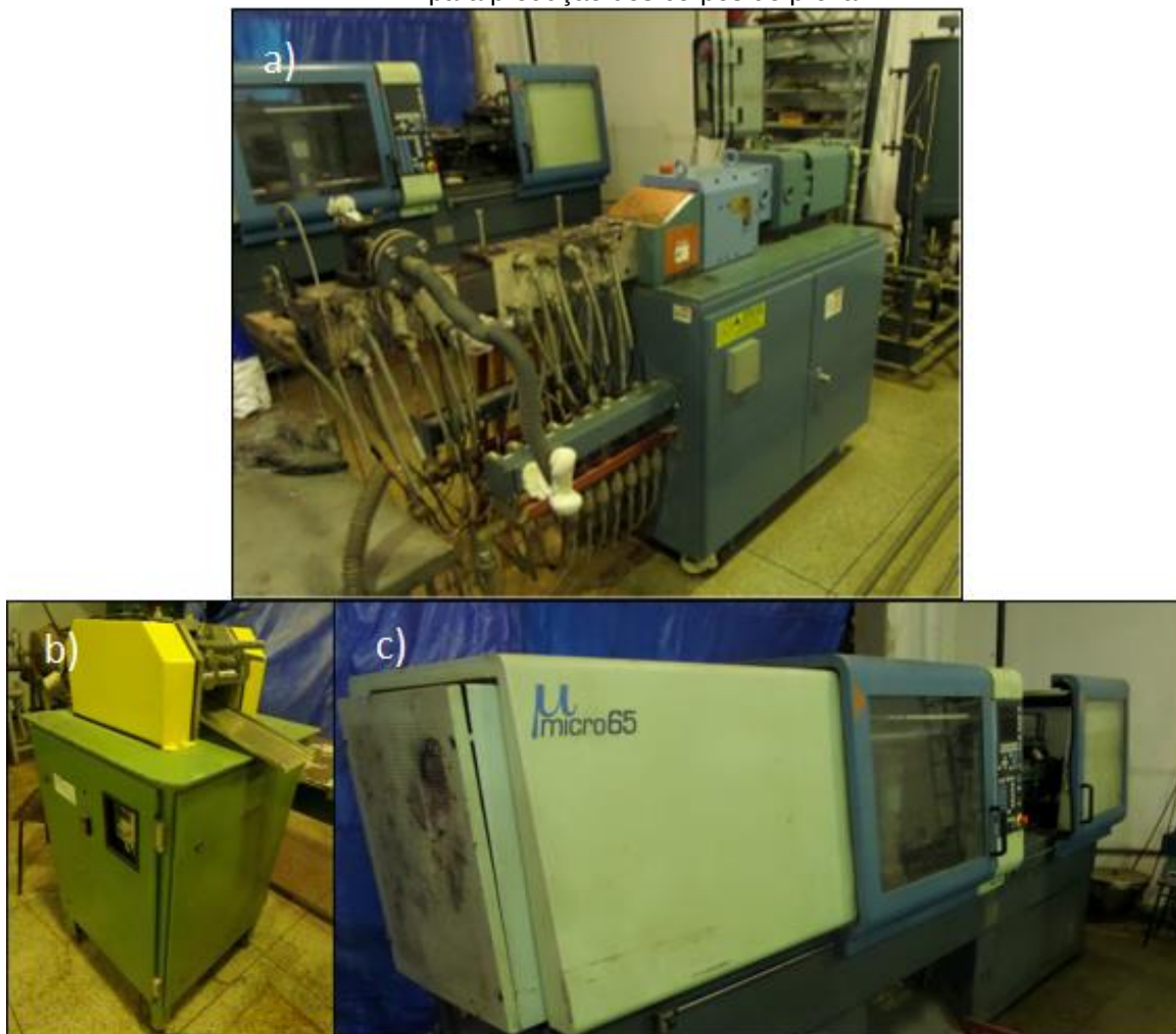
Figura 12. a) Extrusora utilizada para fundir o material e produzir filamentos, b) Picotador e c) Injetora para produção dos corpos de prova.
