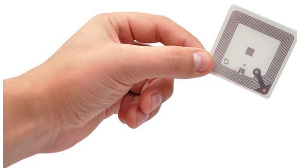
Figura 2.1: Foto de uma tag de RFID passiva de alta frequência. Fonte: https://rfidbrasil.com/ .
