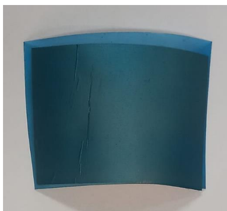
Figura 3.10: Foto do substrato com o filme foto resiste. Tamanho: 25 mm x 50 mm. Fonte: Elaborado pelo autor.
