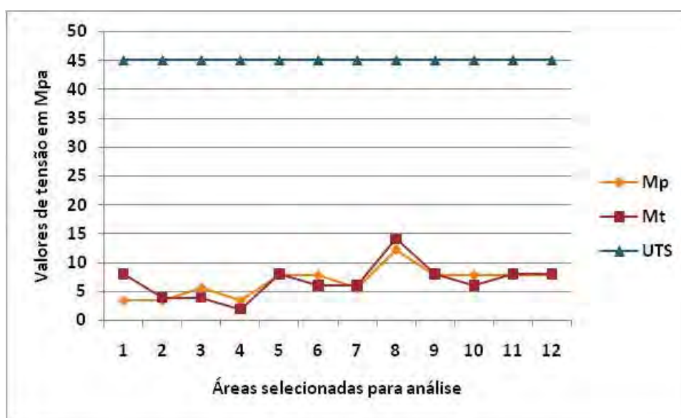
Gráfico 3 – Valores da \sigma_{\max} em tração na camada de cimento resinoso para o M_p e M_t e o valor de ruptura (UTS).
