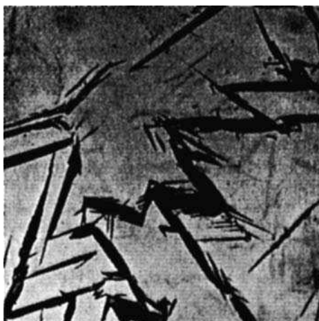
Figura 09 – Microestrutura martensítica com morfologia de ripa em um aço com 1,8 %C.
