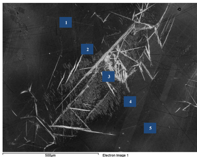
Figura 37 – Amostra homogeneizada – 1150°C / 24 h – Nital. Pontos que tiveram suas composições químicas determinadas por EDS.
