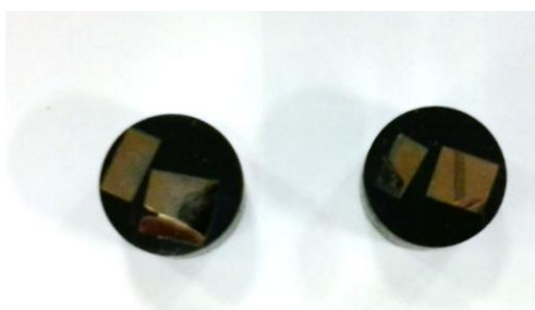
Figura 18 – Seções transversal e longitudinal, embutidas e preparadas para análise após o tratamento térmico
