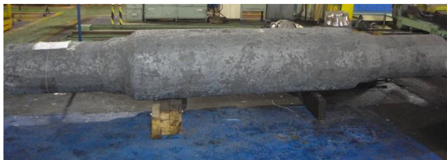
Figura 11 – Fase intermediária - Cilindro bruto de forjamento
