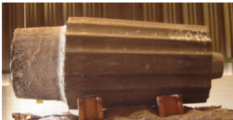
Figura 10 – Fase inicial - Lingote bruto de solidificação
