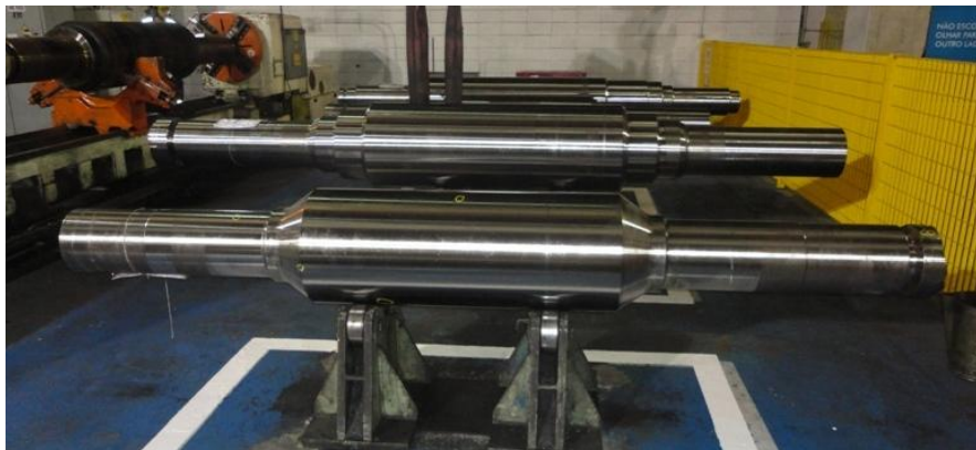
Figura 12 – Fase final - Cilindro acabado conforme dimensional especificado pelo cliente.
