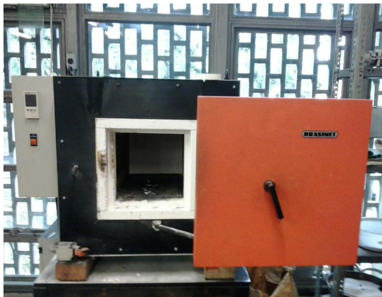
Figura 15 – Forno utilizado nos tratamentos térmicos.
