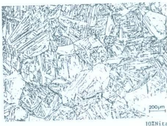
Figura 08 – Microestrutura martensítica ripada após tratamento térmico de homogeneização à temperatura de 1197°C por 10 h.
