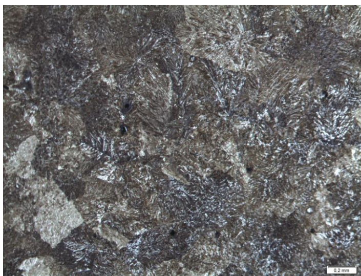
Figura 21 – Amostra bruta de solidificação – \frac{1}{4} de raio - Nital
