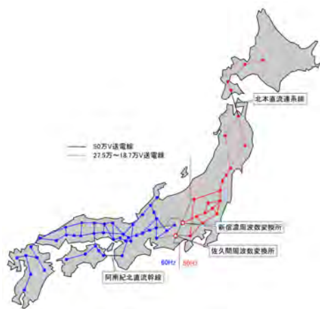
Figura 1: Divisão em comunidade do sistema elétrico Japonês. Em azul está a comunidade que opera a 60Hz e em vermelho a que opera em 50Hz [1].
