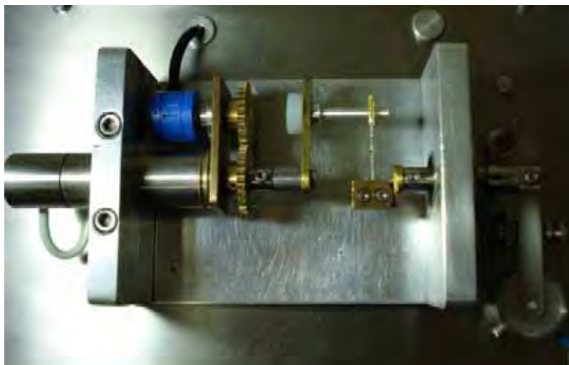
FIGURA 11 – Dispositivo de bancada para teste de dobramento, mostrando o instrumento com a ponta aprisionada pela garra conectada à célula de carga e o cabo apoiado no braço de alavanca conectado ao motor.
