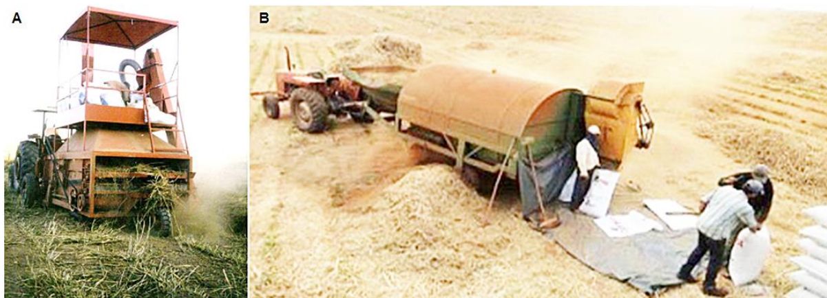
Figura 2. Colheita mecanizada de sementes de gramíneas forrageiras por varredura do chão do campo pela máquina colhedora (A), pré-limpeza grosseira de sementes de Brachiaria brizantha com máquina de peneira cilíndrica denominada de “tufão” ligada na tomada de força do trator e ensacamento no campo (B). (Foto A: ASSE, F.A.M.; PONTES, T.P., 2015; Foto B: MARTINS, C.C., 2015).
