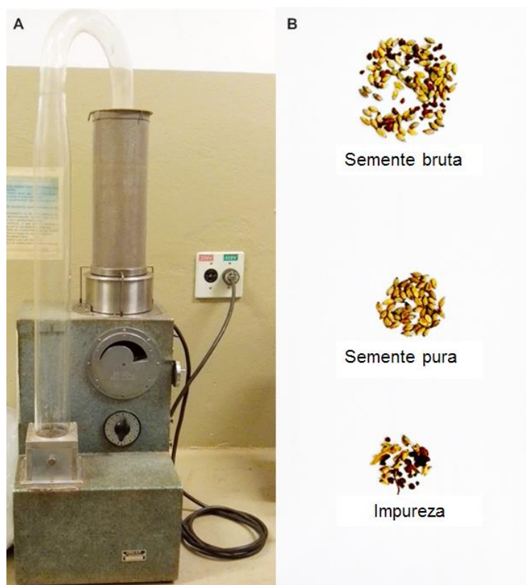
Figura 3. Soprador pneumático (A) e sementes brutas que foram separadas por catação manual em porções de sementes puras e impurezas (B) na análise da pureza de Brachiaria brizantha cv. BRS Piatã. (Foto: SILVA, G.Z., 2017).
