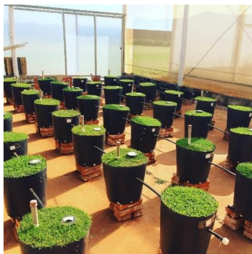
Figura 2. Vasos de 25 l utilizados para o cultivo das espécies de grama e condução do sistema de irrigação por gotejamento subsuperficial.
