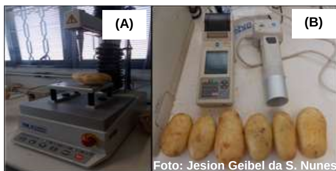
Figura 5 – Detalhe do texturômetro para obtenção da firmeza dos tubérculos (A) e colorímetro para determinação da intensidade de esverdeamento (B)
