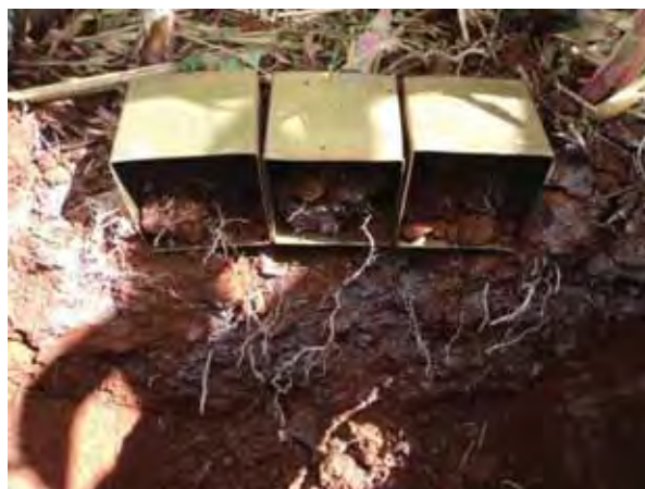
Figura 7. Coletas de raízes na primeira camada (0-0,1 m) com cubo volumétrico.
