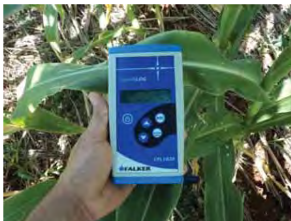
Figura 9. Identificação do teor de clorofila em folhas de milho.
