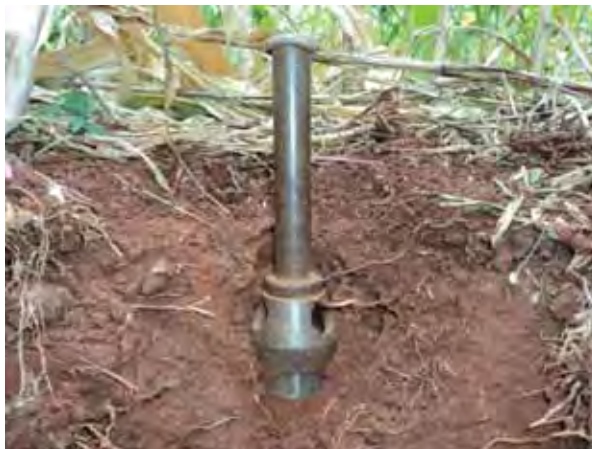
Figura 8. Coleta de anéis para análise física do solo na primeira camada (0-0,1 m).
