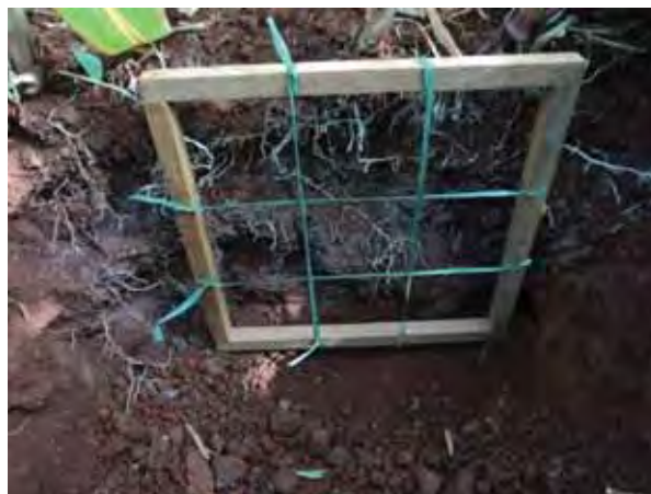
Figura 1. Trincheira para captura de imagens, detalhando as regiões e raízes pintadas.
