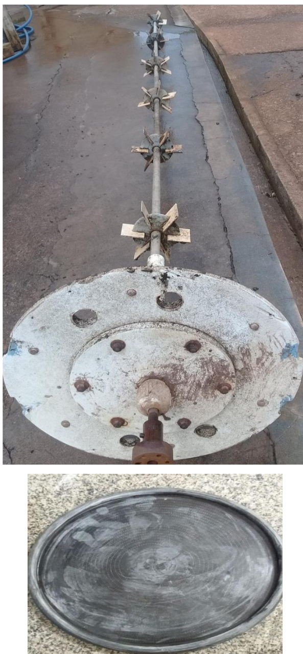
Figura 15. Foto: Hastes rotacionais e membrana de bolha fina, utilizados no reator operado em batelada sequencial.
