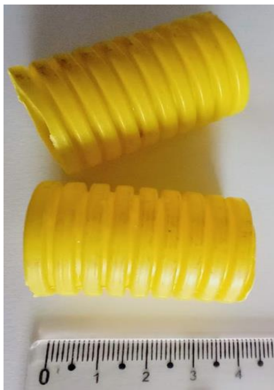
Figura 12. Foto dos anéis de eletroduto conrrugado.
