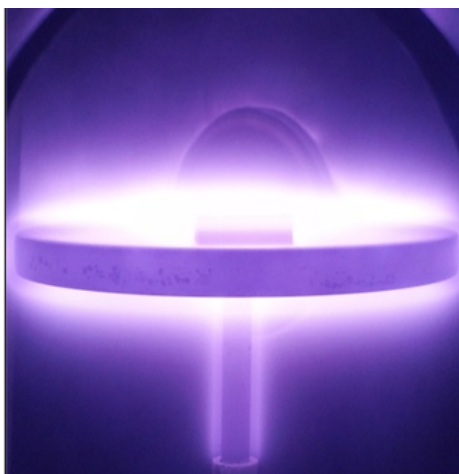
Figura 3 - Formação do plasma em torno do porta amostras dentro da câmara do reator durante a deposição do filme DLC
