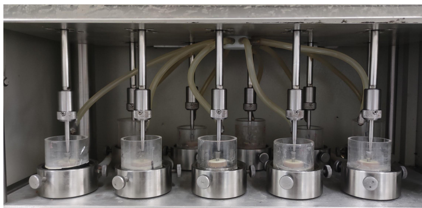
Figura 13 - Cicladora com as 10 amostras posicionadas nos nichos para ensaio de ciclagem mecânica
