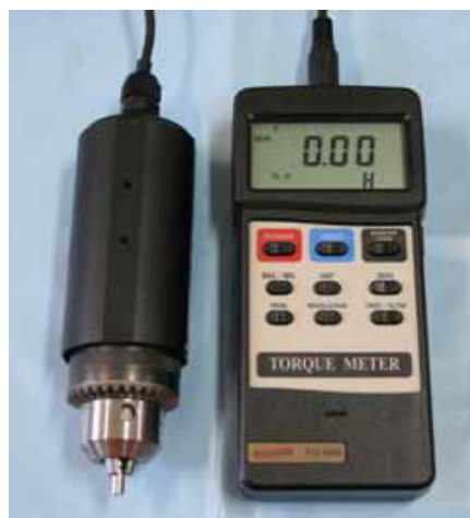
Figura 8 - Torquímetro digital utilizado para aferir o torque nos parafusos de fixação dos pilares
