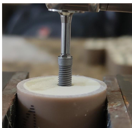
Figura 6 - Inserção do implante no bloco de poliuretano com chave de inserção de torque interno
