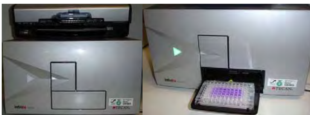
FIGURA 8 – Espectrofotômetro com placa de 96 poços para a realização da mensuração da densidade celular.
