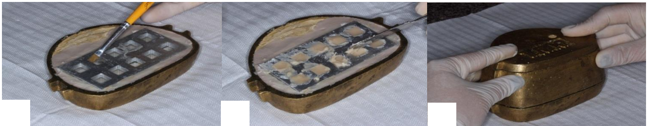
Figura 3: A- Isolamento da matriz metálica. B- Colocação do material RAA. C- Fechamento da mufla.
