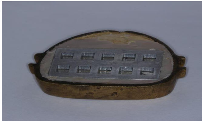
Figura 2: Matriz metálica inclusa em mufla.
