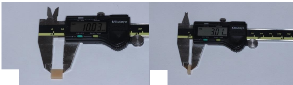
Figura 5: A- Mensuração da altura da amostra. B- Mensuração da espessura da amostra.
