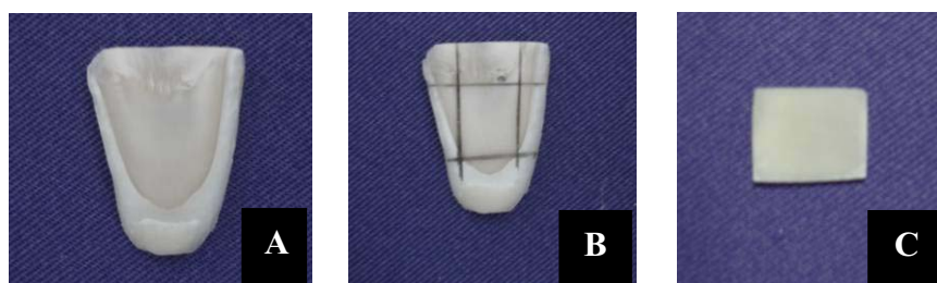
FIGURA 8- Esquema da obtenção da fatia de dentina padronizada. A- fatia de dentina selecionada, B- fatia de dentina demarcada, C- fatia de dentina após recorte com broca de alta rotação.
