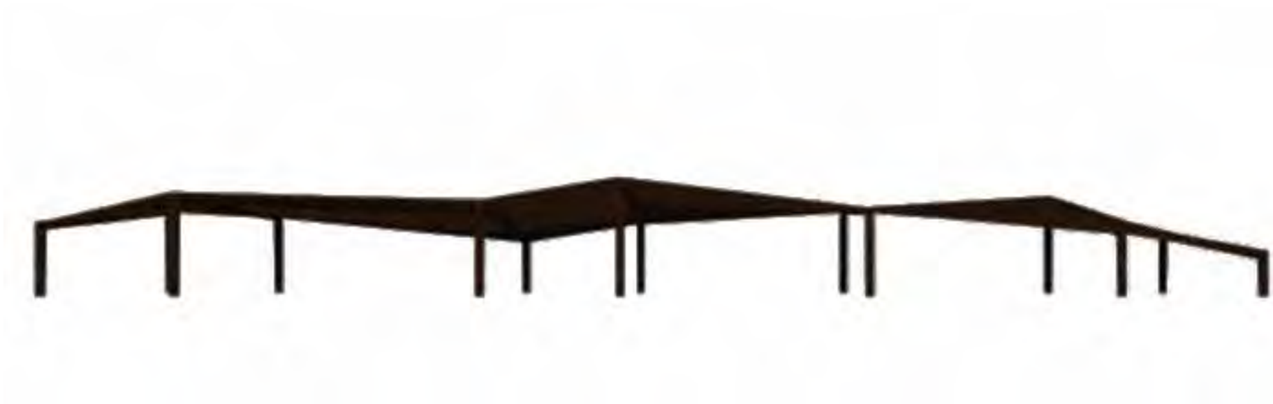
Imagem 59 – Vista frontal da cobertura de madeira laminada colada Fonte: Autora
