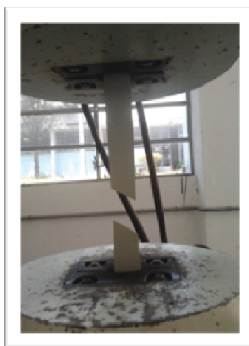
Figura 21: Ensaio de tração da chapa. Fonte: Autor.
