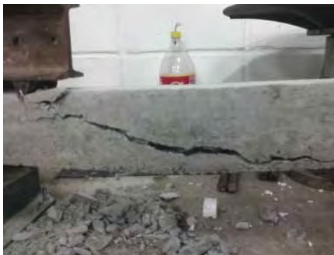
Figura 37: Viga N o 2 Rompida.
