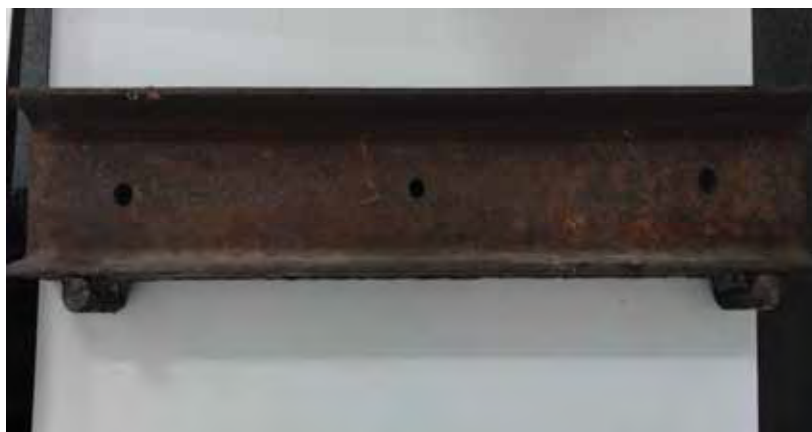
Figura 31: Dispositivo de cargas concentradas. Fonte: Autor.
