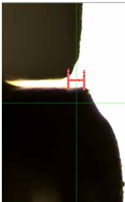
Figura 7 - Maior desadaptação marginal horizontal negativa do pré-molar (-132 \mu\text{m} )
