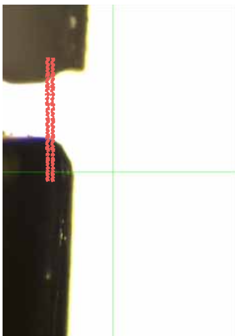
Figura 6 - Menor desadaptação marginal negativa do molar (-2 \mu\text{m} )
