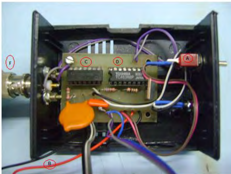
Figura 3.1– Circuito desenvolvido no CEB-UNICAMP. (A) chave liga-desliga; (B) alimentação com bateria; (C) componente gerador de um trem de pulsos; (D) componente controlador da largura de pulso; (E) ganho de corrente com Mosfet IRF510; (F) saída BNC do sinal.
