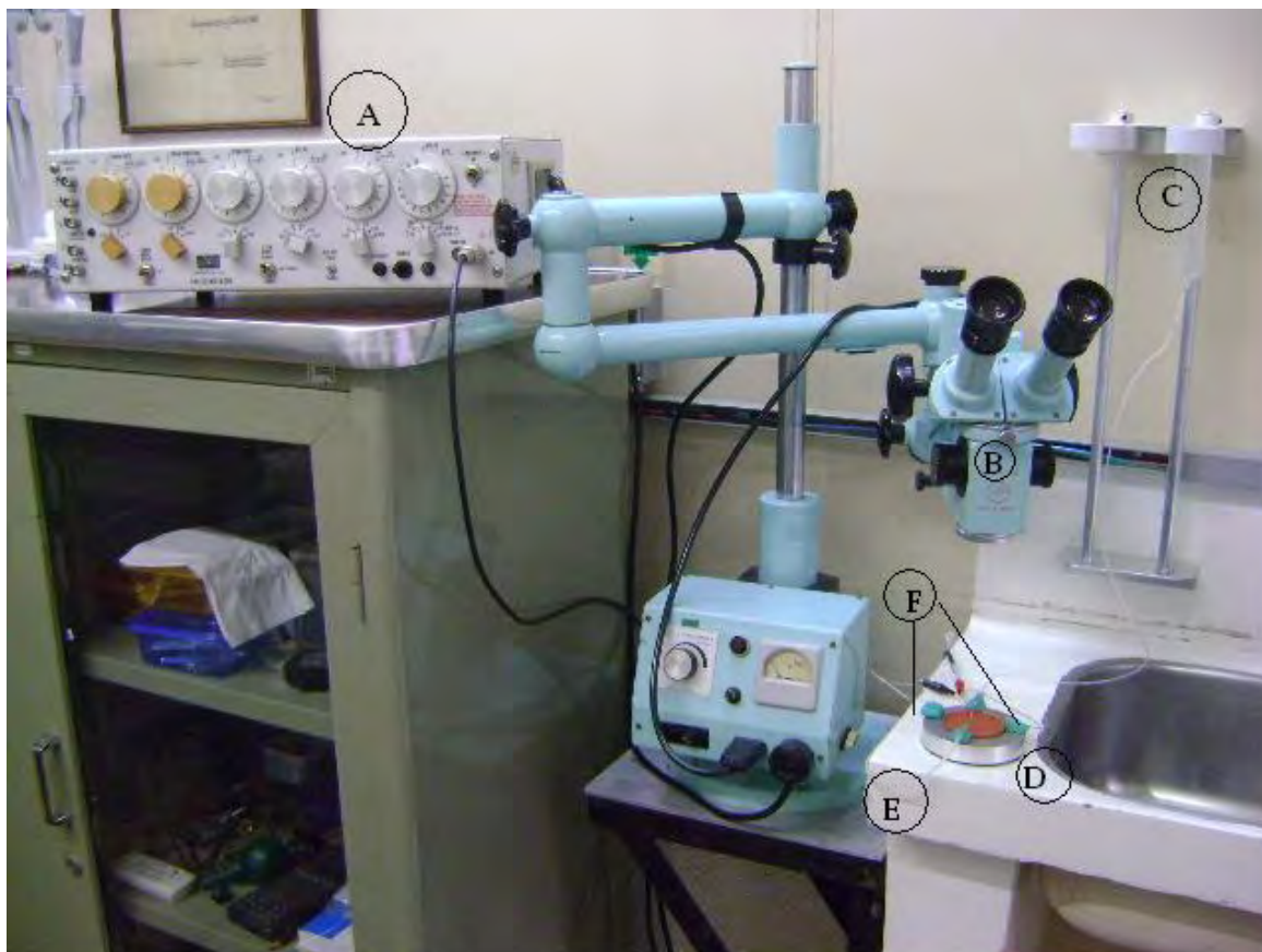
Figura 3.3 – Setup montado especialmente para estudos da frequência cardíaca do coleóptero T. molitor . Estão indicados (A) estimulador monopolar, (B) lupa, (C) sistema de perfusão, (D) câmara de estimulação, (E) sistema de vácuo para circular solução fisiológica e (F) par de eletrodos de aço inox.
