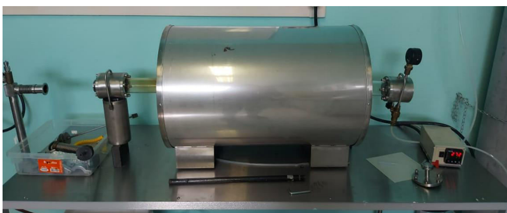
Figura 8 - Forno tubular com tubo de quartzo utilizado no processo de pirólise.
