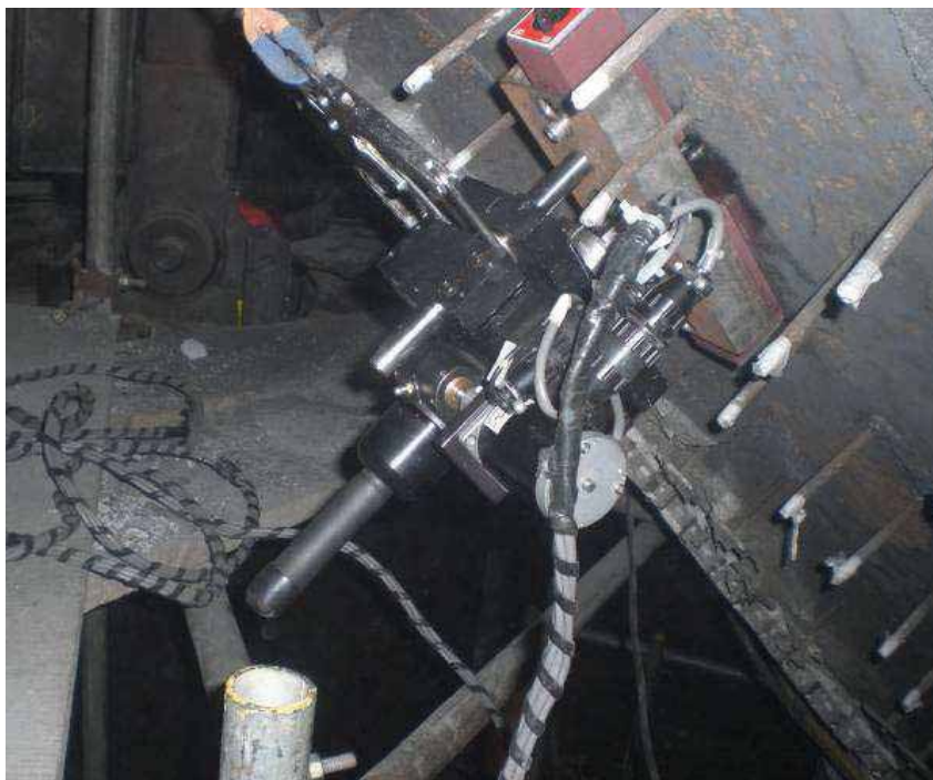
Figura 17 – Equipamento Utilizado para Realizar o Ensaio de Indentação Instrumentada in-situ (RAMOS NETO; GUIMARÃES, 2011)
