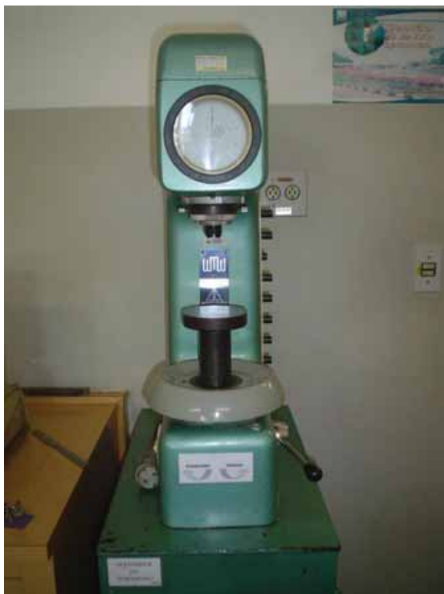
Figura 12 – Máquina de Dureza Heckert da REVAP – Petrobras (ADACHI, 2011)
