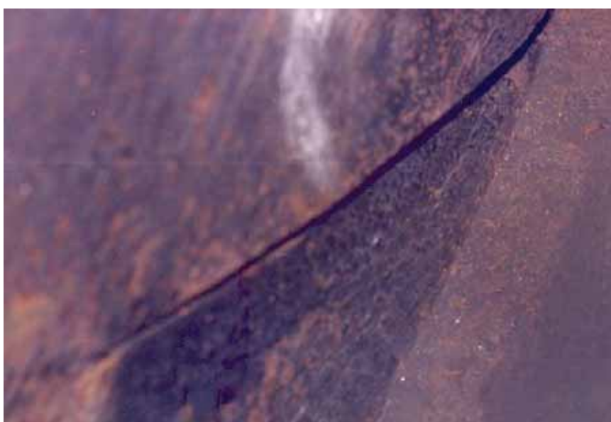
Figura 1 – Fratura Frágil no Riser da RPBC - Petrobras (PALFI et al. , 1988)
