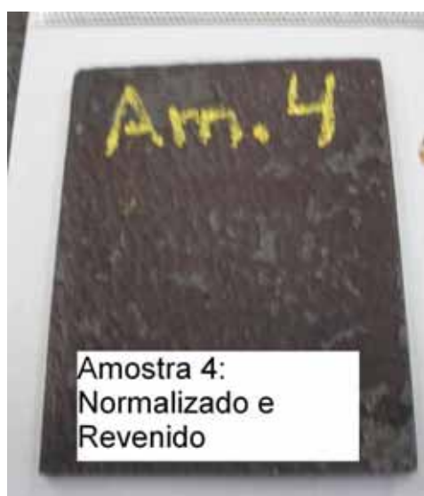
Figura 11 – Amostra 4 do Suporte do Chapéu Chinês (ADACHI, 2011)
