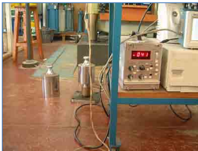
Figura 4.20. Calibração do indicador digital de deformação (modelo TMDE) utilizando peso padrão de massa 10 kgf (ou 41 \mu\epsilon \times 0,25 \text{ kgf}/\mu\epsilon ).
