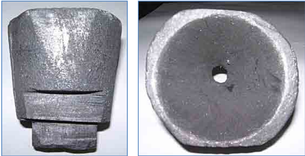
Figura 4.5 Projeto inicial da panela intermediária ( tundish ) feito de grafite objetivando o posicionamento do vazamento na calha de resfriamento.
