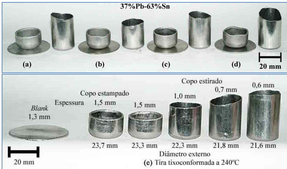
Figura 5.64. Copos obtidos através da estampagem profunda e estiramento das tiras semi-sólidas fundidas a 220 °C (a), semi-sólida fundida laminada (b), tixolaminada a 240 °C (c) e laminada convencionalmente (d). Exemplo da seqüência da operação de estiramento (e).
