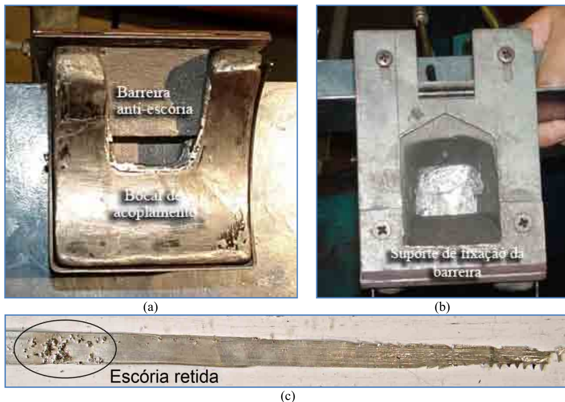
Figura 5.26. Barreira para impedir o arraste de óxido/escória (a), vista superior mostrando o suporte de fixação (b) e a escória retida no final do processamento na cauda da tira (c).
