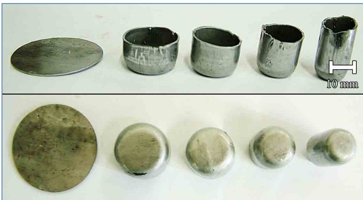
Figura 5.38. Copos metálicos obtidos com quatro tamanhos de matrizes feitos de tiras metálicas fundidas laminadas para diâmetro do disco metálico ( blank ) de 40,2 mm de diâmetro e espessura de 1 mm aproximadamente. Uma grande trinca é formada no copo estampado preferencialmente na curvatura do punção devido a concentradores de tensão (óxido/escória).
