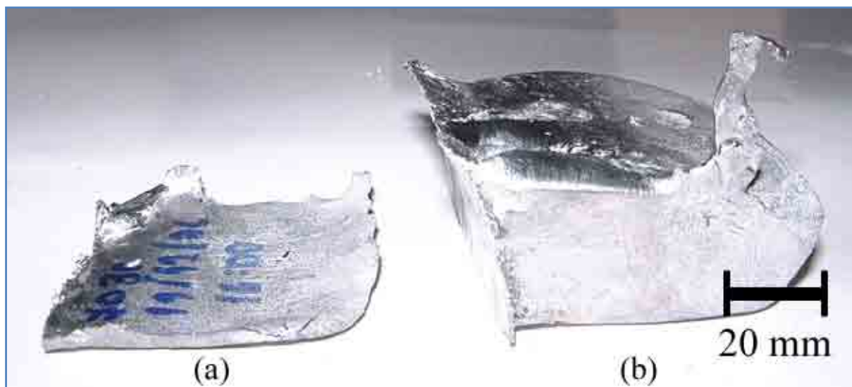
Figura 5.9. Material da liga 70%Pb-30%Sn retido na soleira do bocal com pré-aquecimento (a) e sem pré-aquecimento (b).
