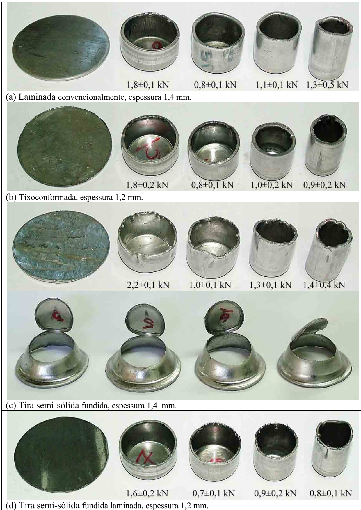
Figura 5.42. Sequências de operação de estampagem profunda das tiras Pb-50%Sn na condição como indicada. As cargas de processamento são indicadas abaixo de cada figura.
