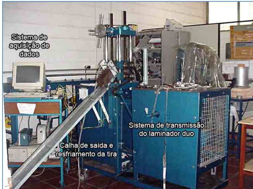
Figura 4.1. Laminador duo irreversível empregado para simular o processo de produção de tiras no estado semi-sólido.
