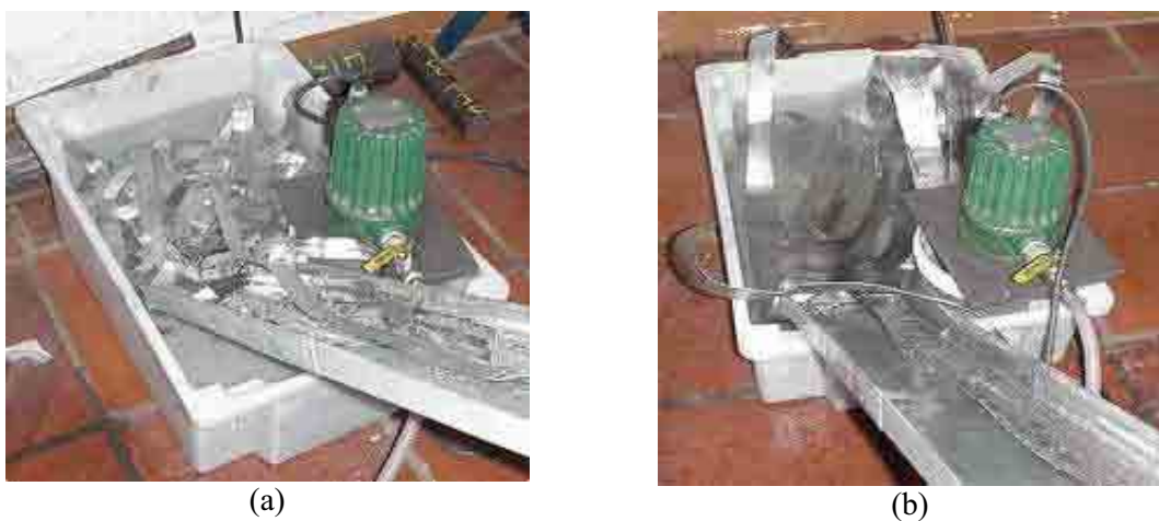
Figura 4. Produto final da tixolaminação da liga de 70%Pb-30%Sn vazada a 350°C mostrando muitos pedaços/lascas de tiras (a). Tira contínua é formada para a liga 50%Pb-50%Sn vazada a 300°C (b).
