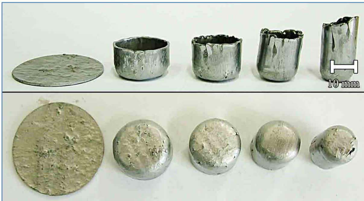
Figura 5.36. Copos metálicos obtidos pelo processo de estampagem profunda e re-estampagem utilizando quatro tamanhos de matrizes para diâmetro do disco ( blank ) de 40,2 mm e espessura de 1,4 mm aproximadamente. Rugas são observadas. Trincas tendem a se formar próxima as inclusões.
