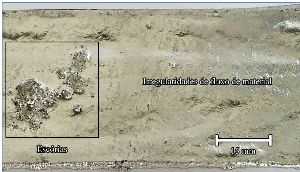
Figura 5.23. Detalhes da Figura 5.22 mostrando escórias e irregularidades do fluxo de material, na superfície da tira semi-sólida fundida voltada para a atmosfera.
