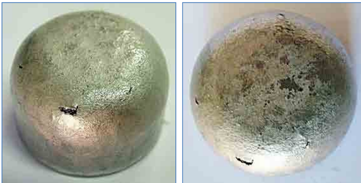
Figura 5.54. Vista da parte inferior do copo mostrando uma superfície áspera lembrando a aparência de “casca de laranja” e trincada, assim não adequada para a operação de estampagem profunda e pintura. Liga Sn-37%Pb. Diâmetro externo do copo 24,3 mm aproximadamente. Processamento com uso da barreira anti-escória. Compare com a Figura 5.35.
