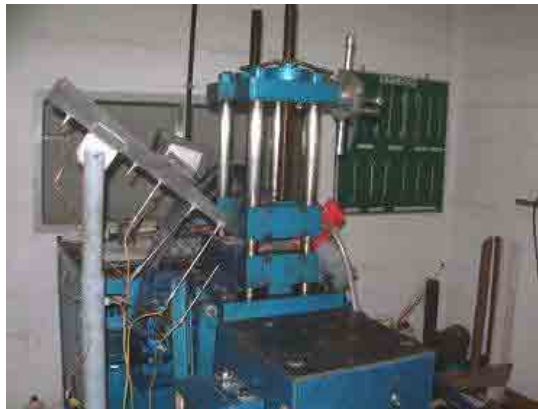
Figura 4: Laminador duo utilizado pelo grupo de pesquisa na obtenção de tiras metálicas.
