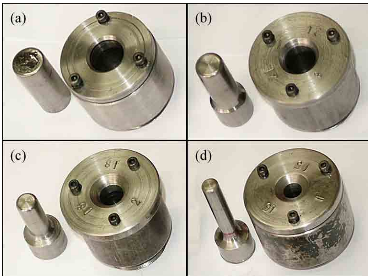
Figura 4.21. Ferramental para a estampagem e re-estampagem profunda: quatro matrizes de diâmetros de 24 mm (a), 21 mm (b), 18 mm (c) e 15 mm (d).
