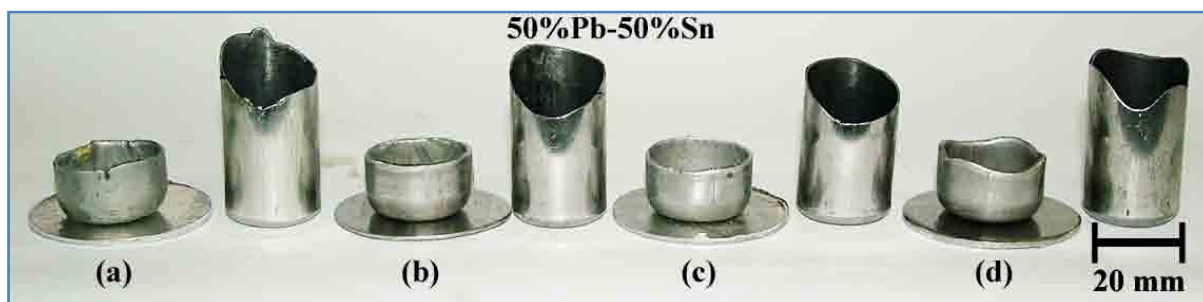
Figura 5.65. Copos obtidos através da estampagem profunda e estiramento ( ironing ) das tiras semi-sólida fundida Pb-50%Sn (a), semi-sólida fundida laminada (b), tixolaminada (c) e laminada convencionalmente (d). O diâmetro externo dos copos estirados é de aproximadamente de 21,6 mm.
