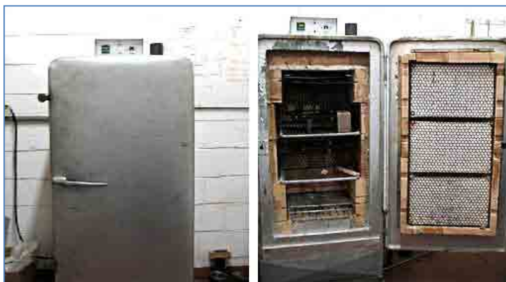
Figura 4.10. Foto ilustrativa do forno mostrando o controlador de temperatura na parte superior e as repartições internas do forno.
