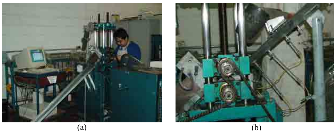
Figura 1. Laminador duo adaptado para o experimento (a). Operação de vazamento (b).
