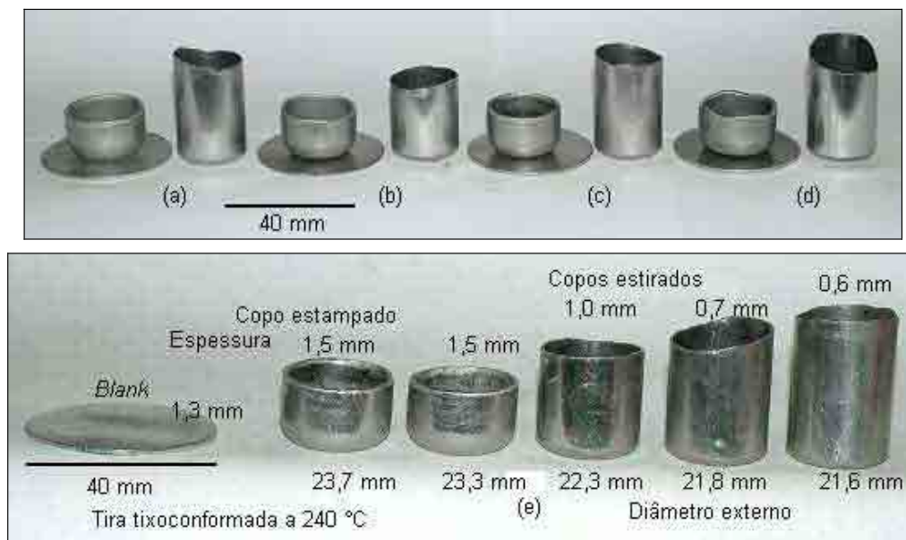
Figura 7. Copos obtidos através da estampagem profunda e ironing das tira semi-sólida fundida a 220°C (a), tira semi-sólida fundida laminada (b), tixolaminada a 240°C (c) e laminada convencionalmente (d). Exemplo da sequência da operação de estiramento (e).
