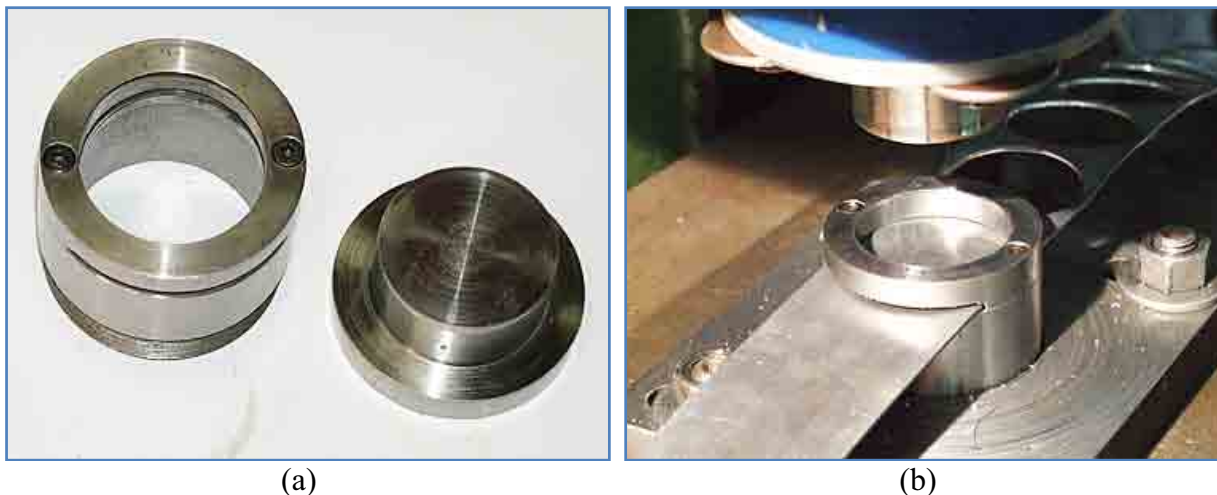
Figura 4.17. Ferramental utilizado no corte dos discos metálicos ( blanks ) (a); processo de corte dos discos ( blanks ) (b).
