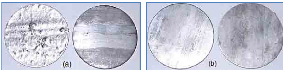
Figura 5.31. Discos metálicos ( blanks ) da liga Pb-30%Sn de 40 mm de diâmetro aproximadamente para a estampagem profunda. Tira semi-sólida fundida, espessura variando de 1,20 a 1,40 mm (a), e semi-sólida fundida seguida de laminação, espessura de 0,83 mm aproximadamente (b).
