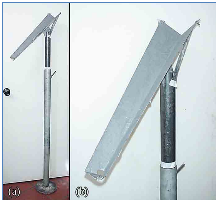
Figura 4.4. Suporte da calha de resfriamento (a); e detalhes da calha mostrando o mecanismo de controle de altura e ângulo da mesma (b). A calha foi pintada com desmoldante a base de grafite coloidal (Dycote 176).
