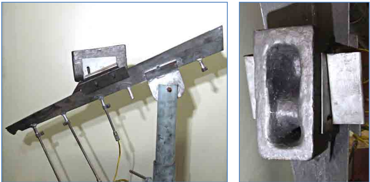
Figura 4.6. A panela intermediária ( tundish ) atual feita de material refratário (sílico aluminoso poroso de fácil moldagem) para o controle estático do fluxo durante a operação de vazamento. A calha de resfriamento já instrumentada com termopares cromel/alumel tipo K de 3 mm de diâmetro.
