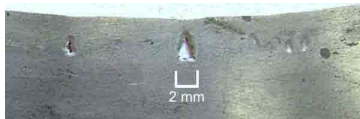
Figura 5. Furos de geometria triangular de diversos tamanhos dispostos ao longo da borda da tira após a simulação da laminação a quente.
