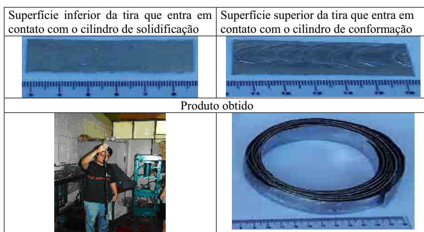
Figura 2 – Aspecto da tira tixolaminada continuamente a 85 rpm (velocidade de saída da tira de 30m/min) a partir da liga Pb-40%; Sn-60% fundida a 300°C.
