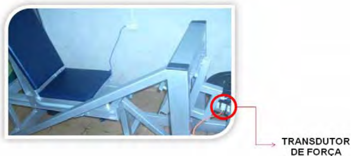
Figura 2. Leg Press , exercício empregado para mensuração da Cf-tempo isométrica e transdutor de força (EMG System do Brasil).
