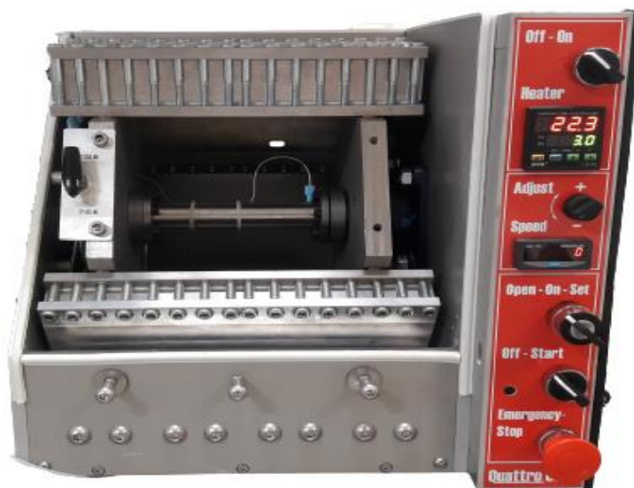
Figura 2 – Coluna hidrostática do cromatógrafo de partição centrífuga modelo Quattro CPC™ (AECS - QuikPrep Ltd.).
