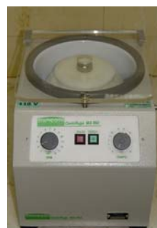
Centrífuga de células para tubos Eppendorf utilizada na lavagem de células bacterianas
