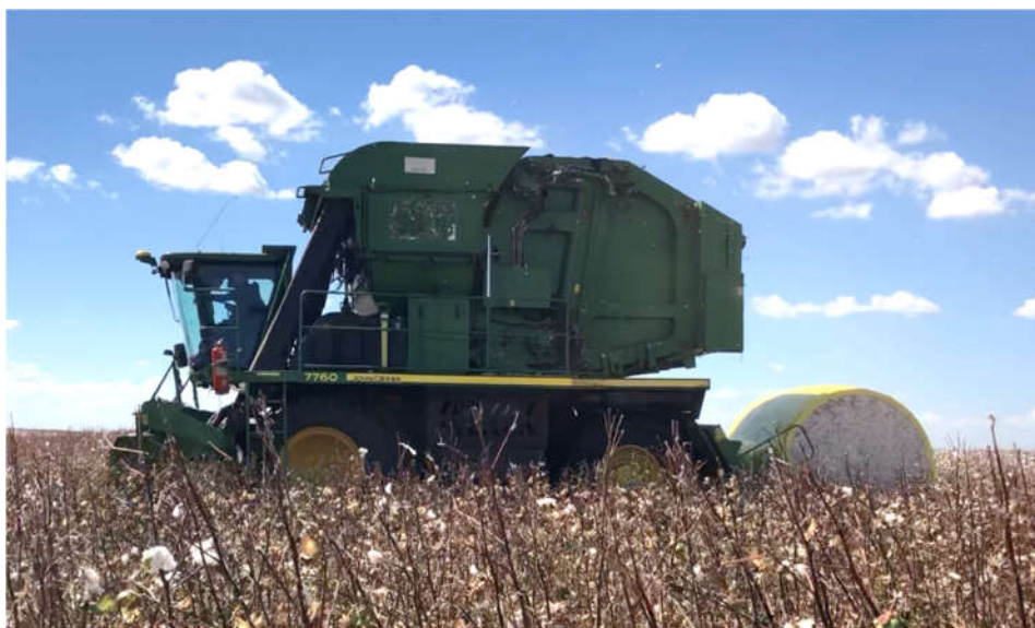
Figura 5. Colhedora JD 7760, que possui câmara de enfardamento de módulos interno possibilitando-a colher, prensar, enfardar e depositar o fardo no campo sem parar a máquina. Foto: Francielle Morelli Ferreira.
