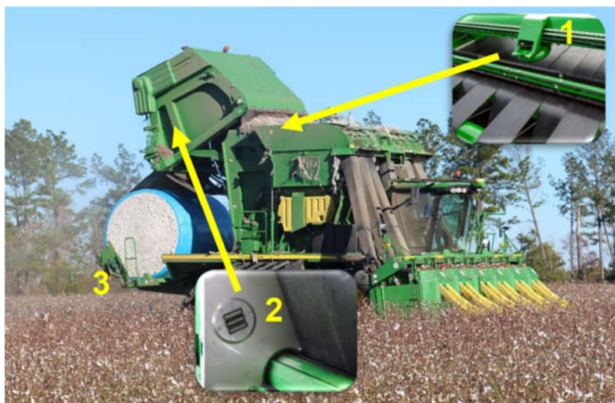
Figura 6. Colhedora CP690 representando o equipamento associado ao sistema de rastreador de colheita (HID cotton system). 1) Leitor RFID presente no acumulador do coletor. 2) Medidor de umidade embutido na lateral do acumulador. 3) Sistema de pesagem hidráulico integrado à plataforma traseira. Fonte: Fuhrer (2022).
