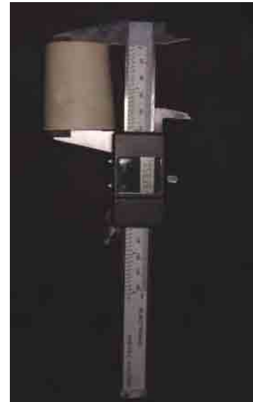
Figura 5 – Mensuração do comprimento final com o paquímetro Electronic Digital Calipers – Starret, U.S.A – graduação de 0,01mm
