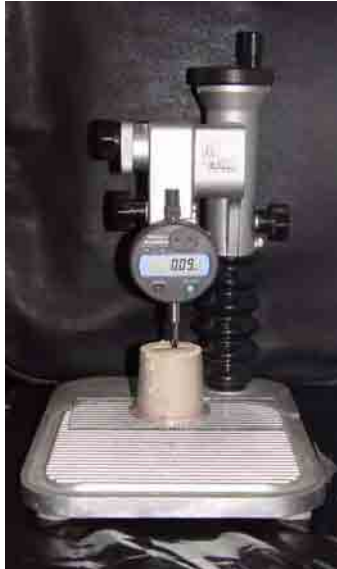
Figura 4 – Mensuração da estabilidade dimensional com relógio comparador (Absolute ID-S1012M – Mitutoyo Corp., Tóquio, Jp) devidamente posicionado.
