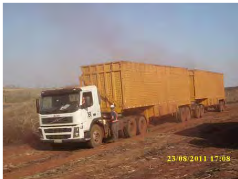
Figura 14 - Representa a etapa de engate de caminhão ao vagão.
