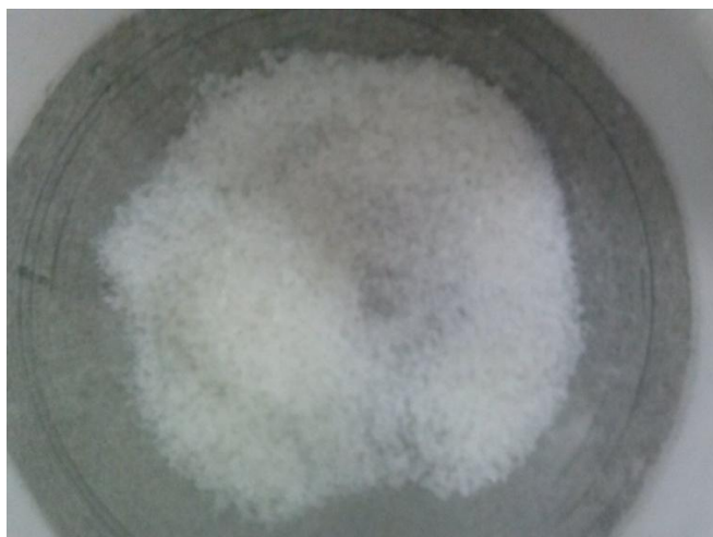
Figura 11: Hidrogel sintetizado com PAAm e CMC, triturado e seco.
