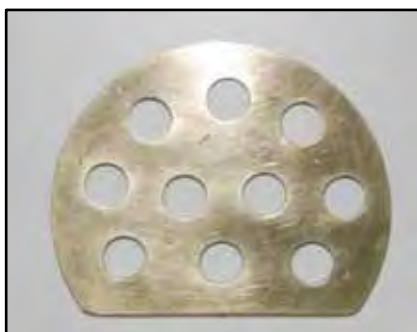
Figura 1- Matriz metálica contendo cavidades de 10 mm de diâmetro x 2 mm de espessura. Araraquara, 2013.
