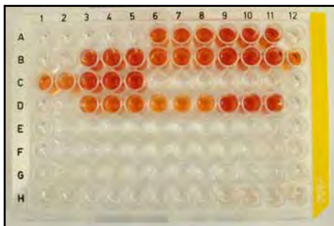
Figura 5 - Produto da degradação do XTT após 3 h de incubação em uma placa de elisa para leitura em espectrofotômetro. Araraquara, 2013.
