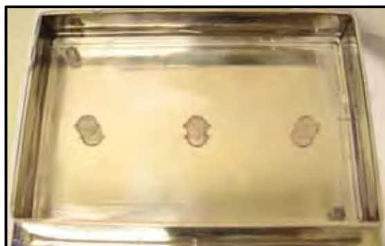
Figura 3 – Base horizontal acrílica removível onde se encaixam os corpos de prova durante os ensaios de escovação. Araraquara, 2013.
