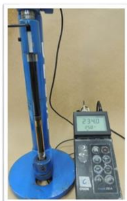
Fluoreto- Eletrodo específico (Orion 9409) - Eletrodo de referência (Orion 900200) - Analisador de íons (Orion 720A+).
