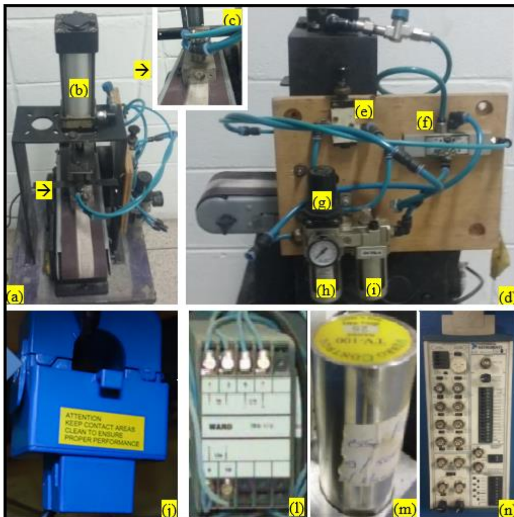
Figura 15- Esquema dos componentes da estrutura do banco de ensaios onde realizou os testes de lixamento.
