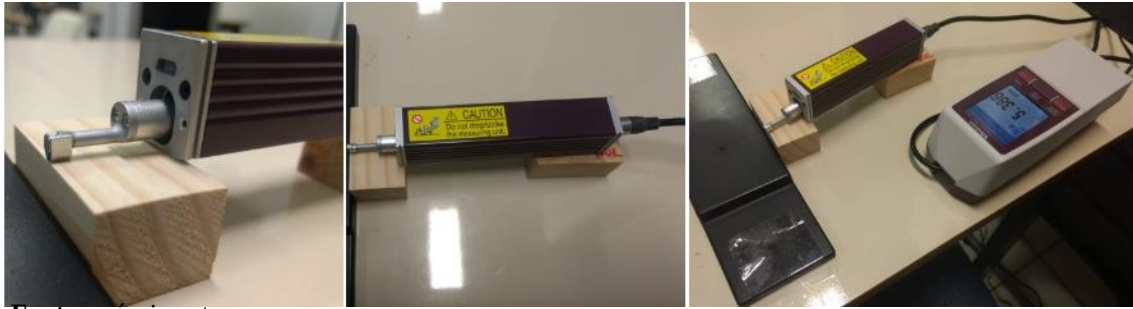
Figura 17- Processo de medição da rugosidade.
