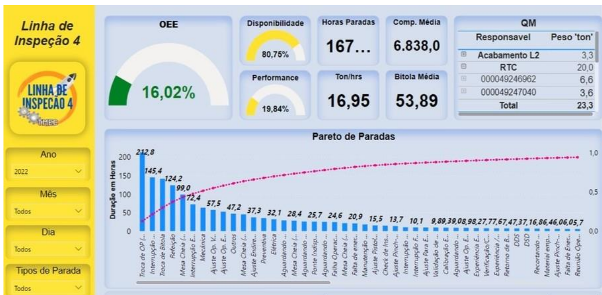
Figura 3 – Gráfico de Pareto - Paradas da linha de inspeção em 2022.
