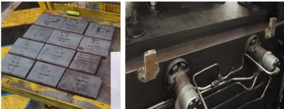
Figura 9 – Calços utilizados no ajuste da mesa guia.
