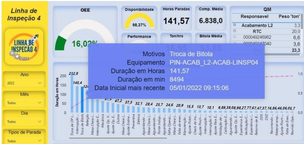
Figura 4 – Gráfico de Pareto - Paradas por troca de bitola da linha de inspeção em 2022.
