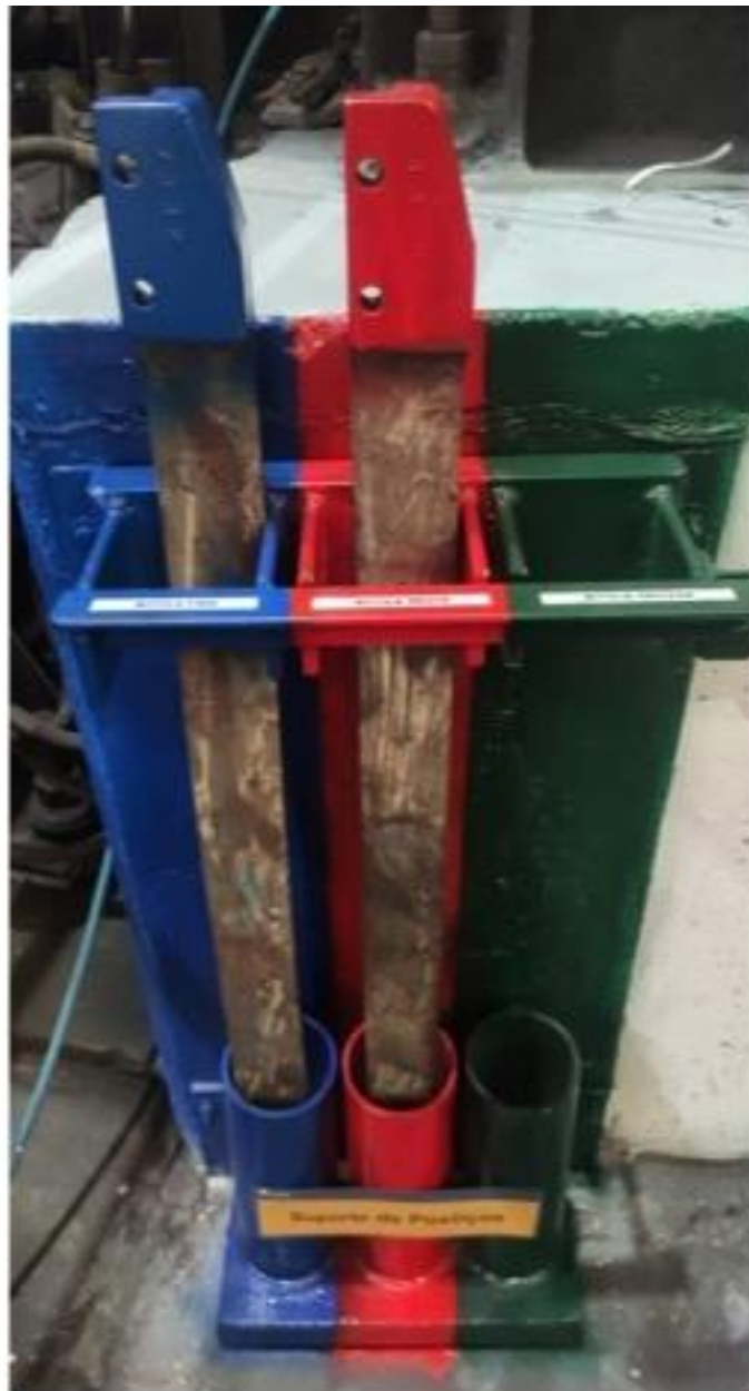
Figura 8 – Suporte para posições instalado na parte traseira da endireitadeira.
