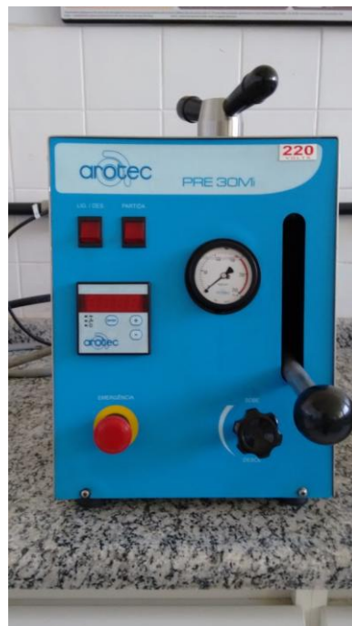
Figura 3.3 – Equipamento para embutimento – DMT-FEG-UNESP.
