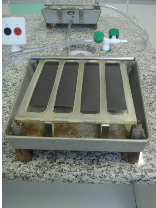
Figura 3.6 – Lixadeira contendo seqüência de lixa d'água – DMT-FEG-UNESP.
