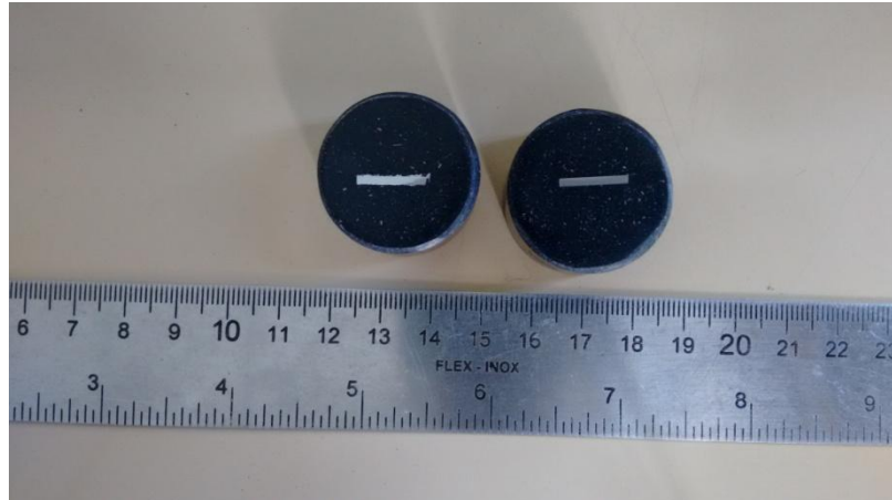
Figura 3.4 – Amostras metalográficas após embutimento – DMT-FEG-UNESP.
