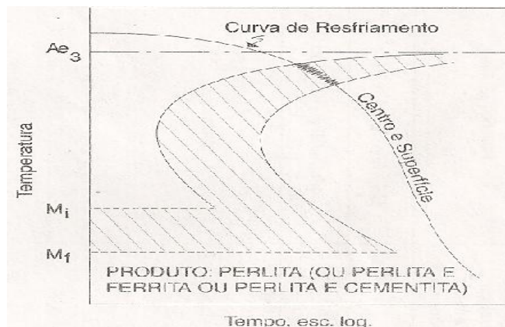
Figura 2.18 – Diagrama esquemático de transformação para recozimento pleno.
