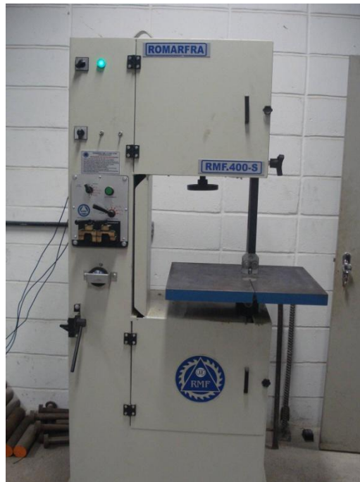
Figura 3.1 – Máquina de corte por serra de fita vertical – DMT-FEG-UNESP.
