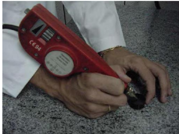
Figura 3.5 - Marcação de amostra utilizando gravador vibrador – DMT-FEG-UNESP
