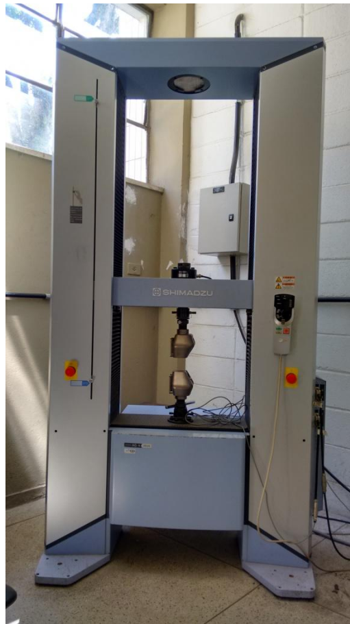
Figura 3.10 – Máquina para ensaio de Tração DMT – FEG – UNESP.
