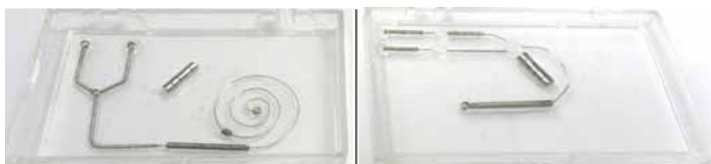
Figura 27: apresentação dos moldes preparados em acrílico, utilizando cilindros metálicos a fim de configurar os canais empregados na preparação dos dispositivos de borracha natural.
